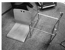
音楽練習室の椅子の中にはネジがゆるみ座面と骨組みが分解してしまうものもあり危険。
